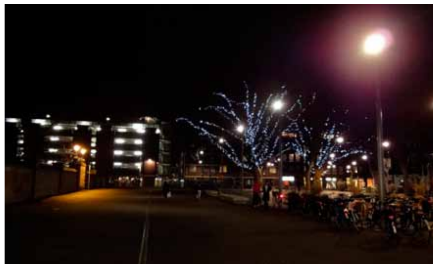
Boven: een te lage mast met daardoor te horizontaal afgestelde armaturen zorgt vaak voor veel verblinding.
